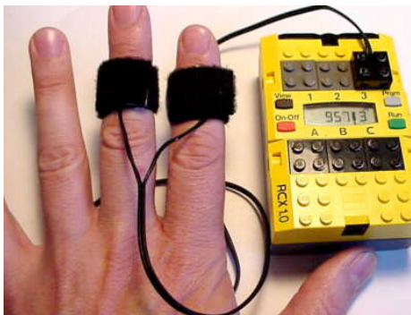
Figura 4.4 Aparelho para medida de resposta de condutância de pele. Fonte: http://www.cultnews.com/?m=200603
